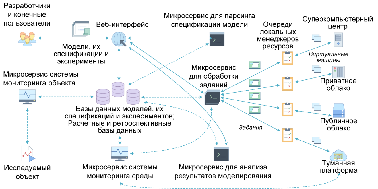
Рисунок 5.10 – Схема организации вычислений на основе предложенного микро-сервисного подхода
