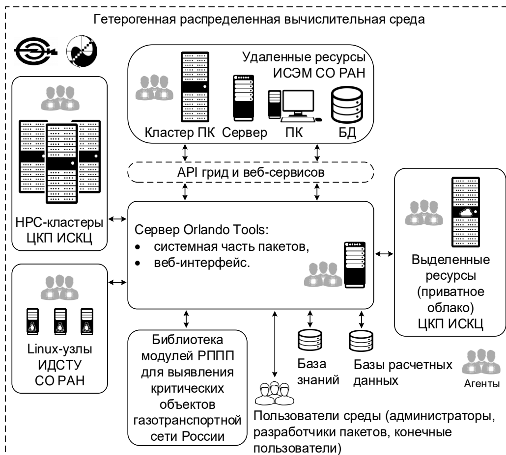
Рисунок 6.2 – Схема интеграции вычислительных систем
