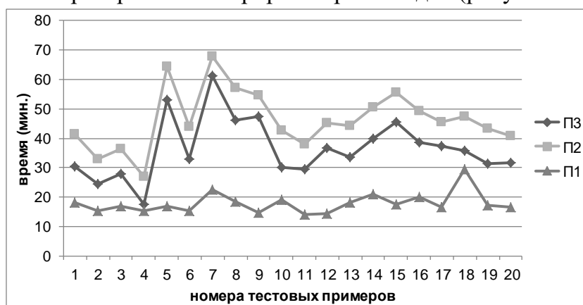
Рисунок 12 – Результаты оценки временных затрат на разработку БЗ разными подходами: П1 – концептуальное моделирование + KBDS/PKBD; П2 – концептуальное моделирование + CLIPSWin; П3 – CLIPSWin
