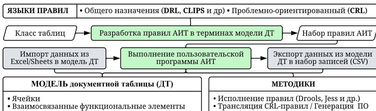
Рисунок 13 — Метод автоматизации АИТ: основные шаги и компоненты
