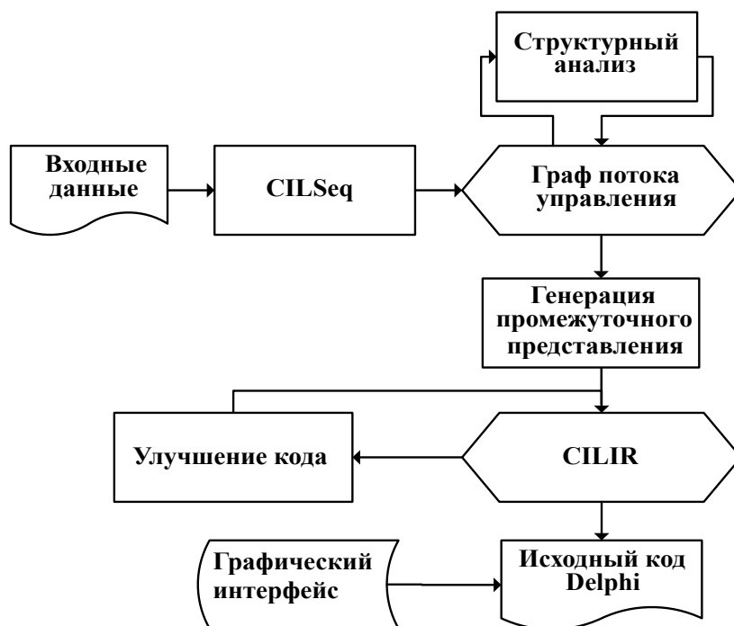
Рис. 2. Архитектура декомпилятора DCUIL2PAS.
