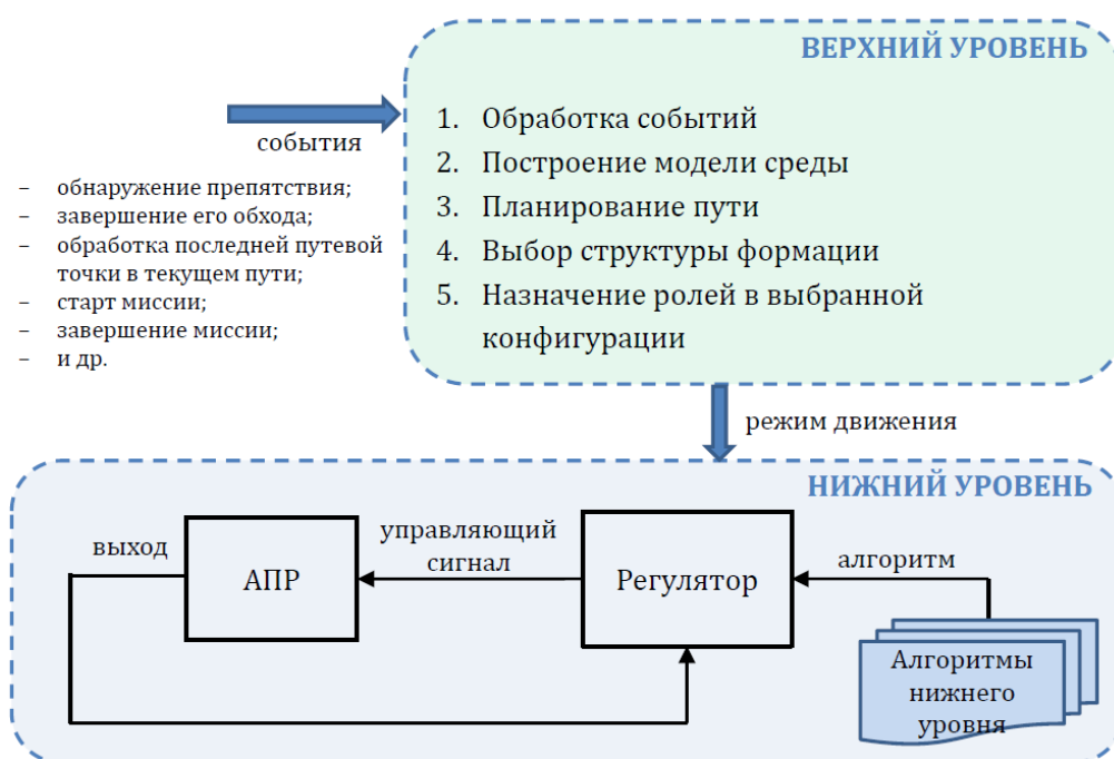
Рисунок 8 – Двухуровневая система управления АПР
