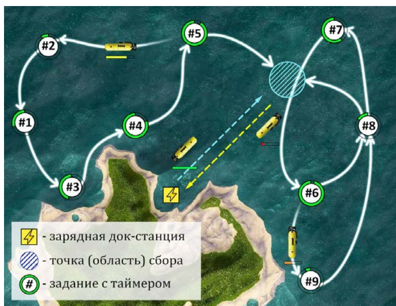
Рисунок 6 – Схематическое представление выполнения миссии по длительному мониторингу акватории группой АПР с непостоянным составом
