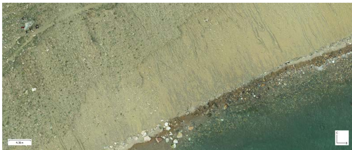
Абразионный размыв подножия берегового склона
