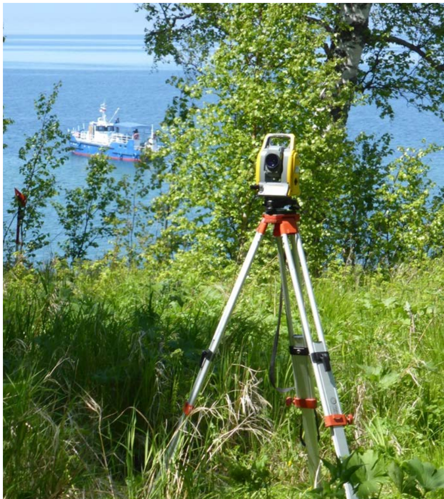
Современный тахеометр (Trimble TS-650) (на заднем плане НИС «Геолог» ИЗК СО РАН)
