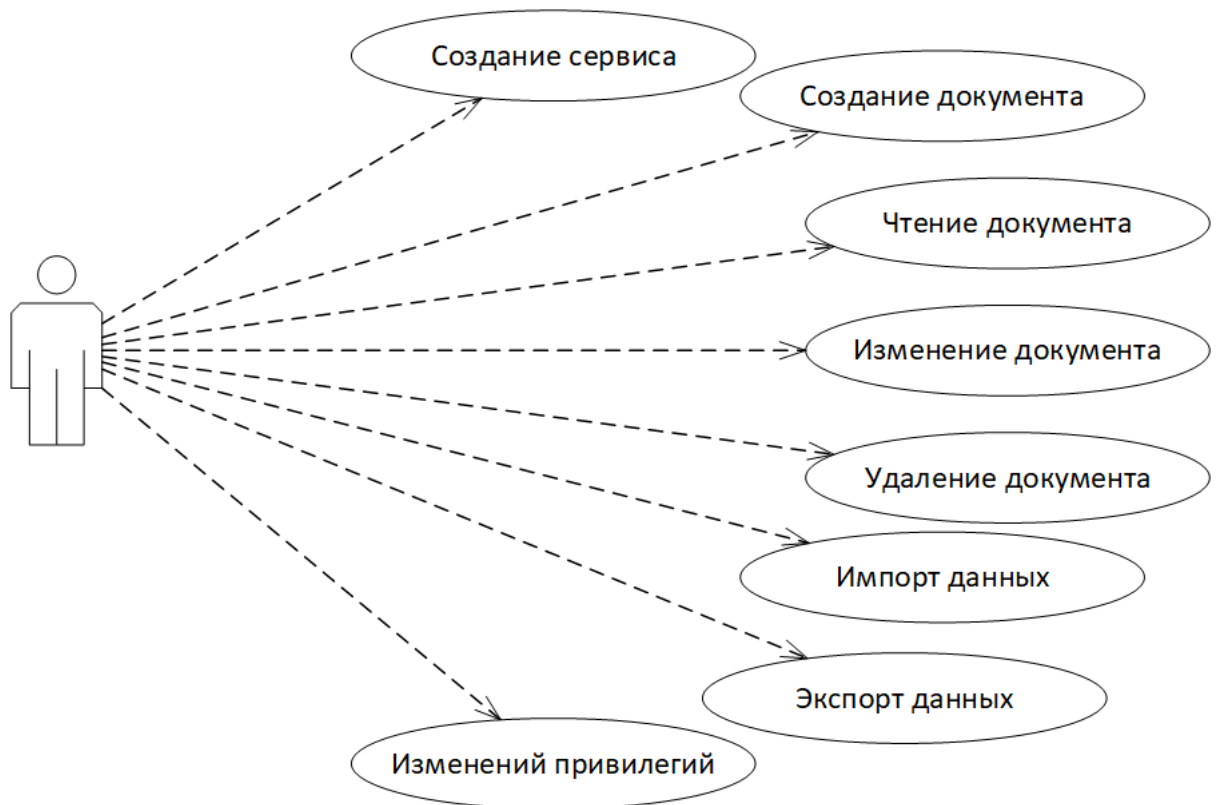
Рисунок 3.4 – UML, диаграмма использования сервисов ввода и редактирования реляционных данных
