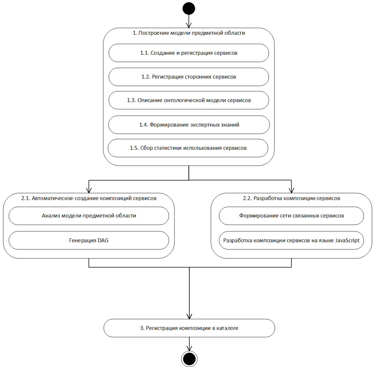
Рисунок 2.1 – Схема метода формирования композиций сервисов
