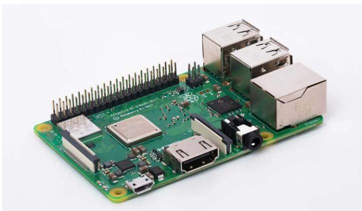
Рис. 1. Raspberry Pi 3 Model B+
