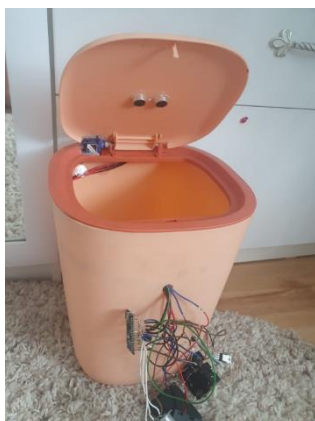
Рис. 2. Стадия внедрения электронных компонентов в корпус
