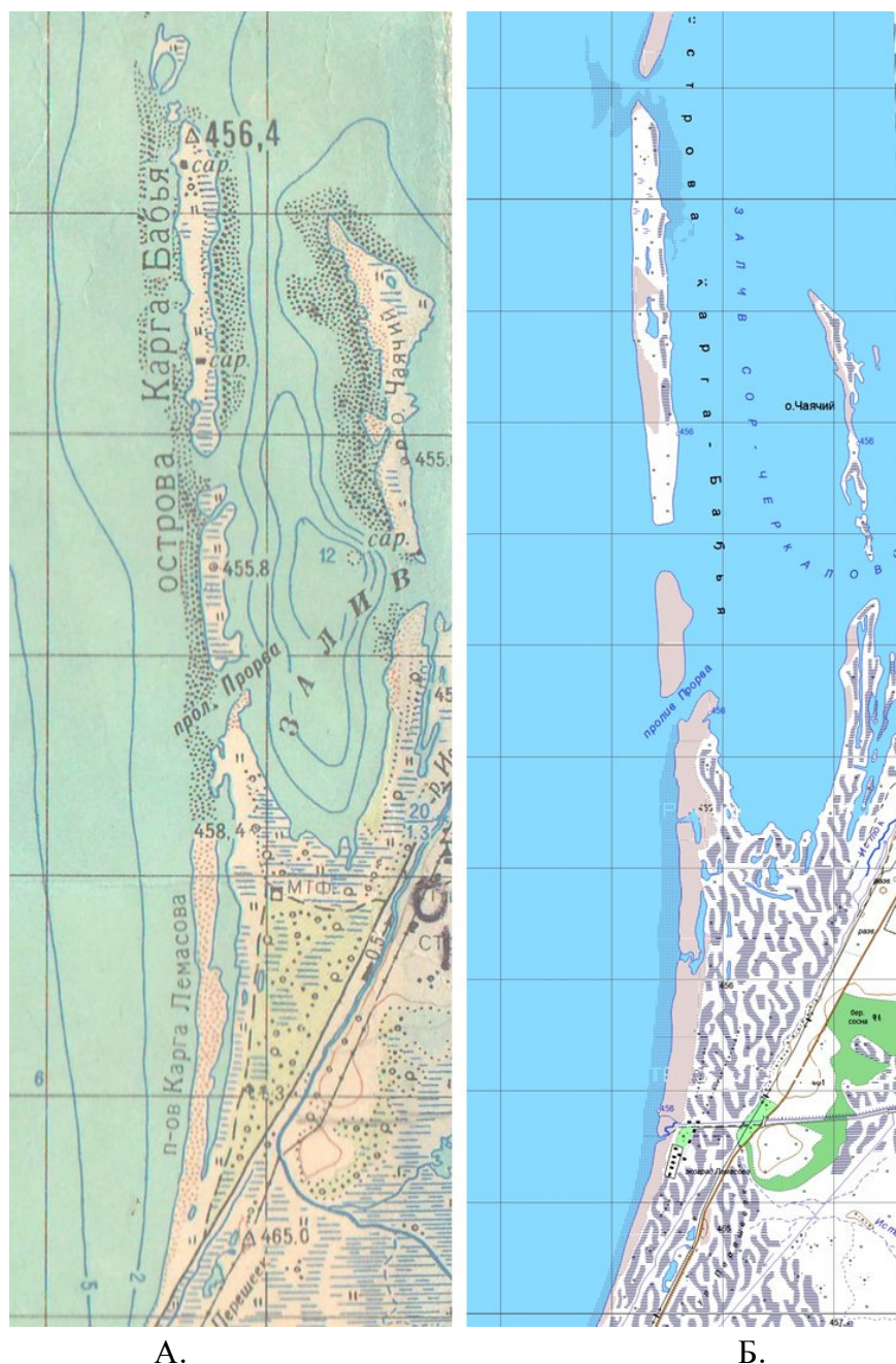
Рисунок 1.1.14 – Карты побережья озера Байкал в районе с. Исток (М 1:50000): А – по результатам геодезической съемки 1942 г., Б – по результатам съемки 2011 г.
