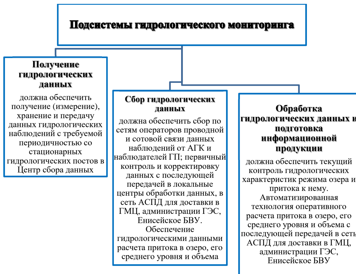
Рисунок 3.2.5 – Блок-схема подсистемы гидрологического мониторинга в бассейне озера Байкал
