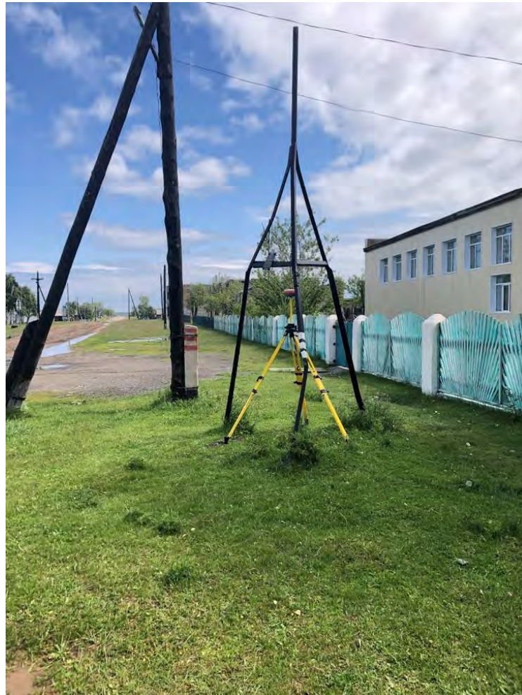
Рисунок 2.2.7 – ГНСС-приемник в качестве базовой станции на пункте ГГС
