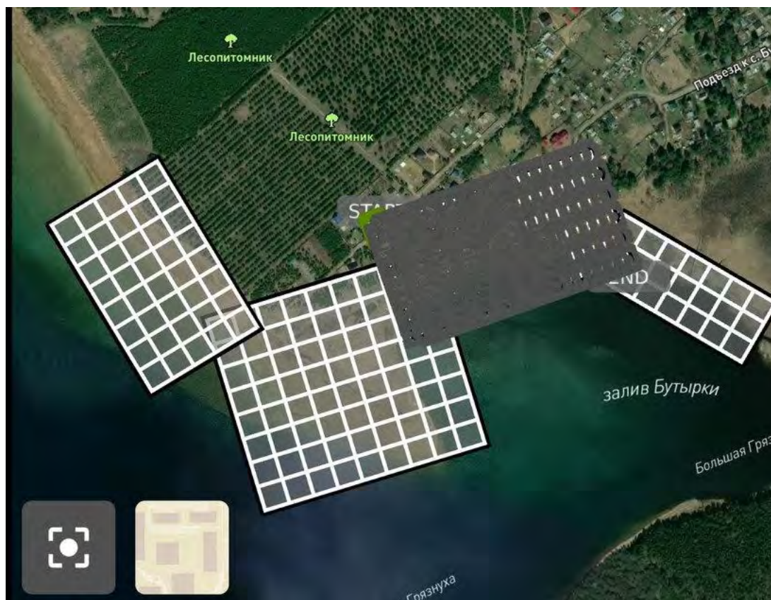
Рисунок 2.2.4 – Построение маршрутов для БПЛА в автоматическом режиме
