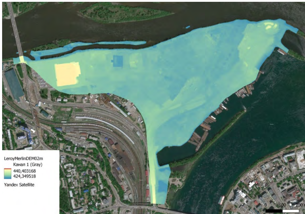
Рисунок 2.3.4 – Полученная растровая модель рельефа для участка в районе Иркутского моста на фоне Яндекс спутник. Разрешение – 20см/пиксель
