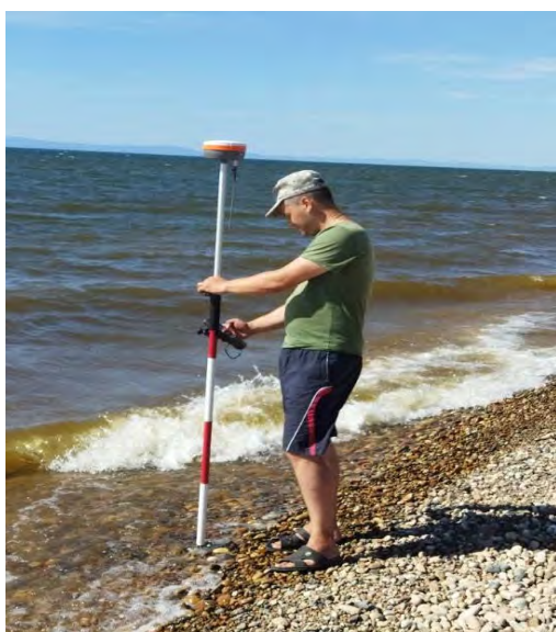
Рисунок 2.2.8 – Работы по промеру глубин
