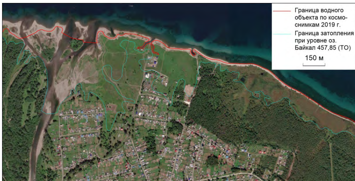
Рисунок 1.5.2 – Схема затопления в устье р. Утулик при уровне оз. Байкал 457,85 м ТО
