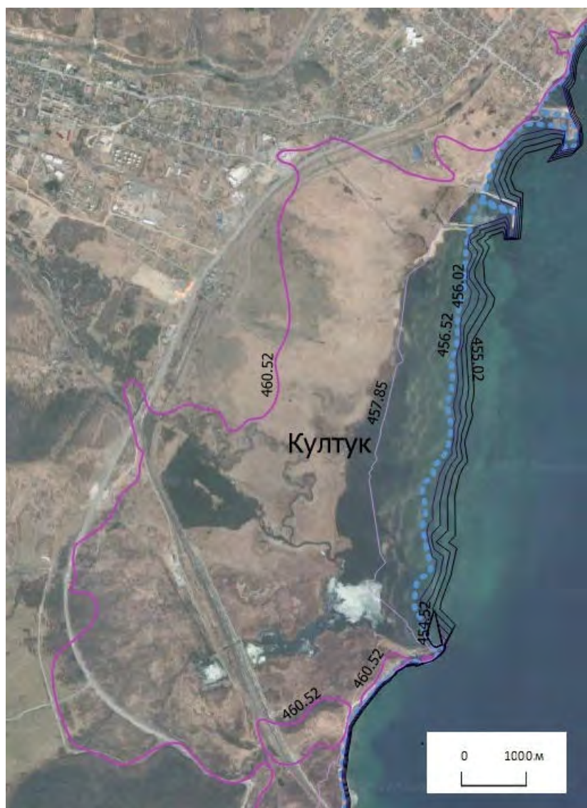
Рисунок 2.2.13 – Пример определения зон затопления/осушения с построением предельных и промежуточных изолиний на ключевом участке (поселок Култук)
