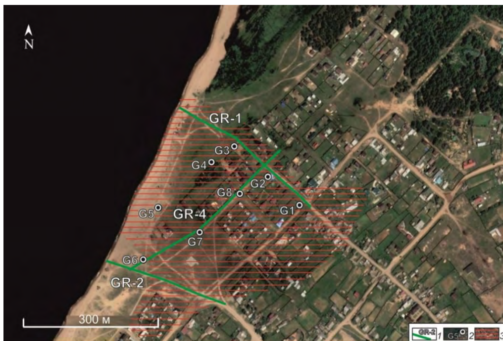
Рисунок 1.1.16 – Космоснимок с. Гремячинск. Условные обозначения: 1 – расположение георадарных профилей, 2 – места бурения гидрогеологических скважин, 3 – территория подверженная умеренному подтоплению
