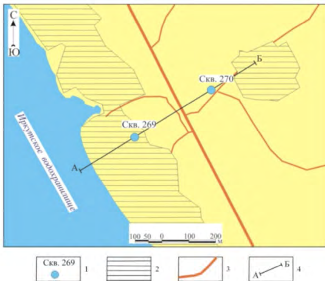
Рисунок 1.1.9 – Схематическая гидрогеологическая карта участка пос. Ангарские Хутора: 1 – скважина опорной государственной сети, номер; 2 – застройка; 3 – автодороги; 4 – линия геолого-гидрогеологического разреза
