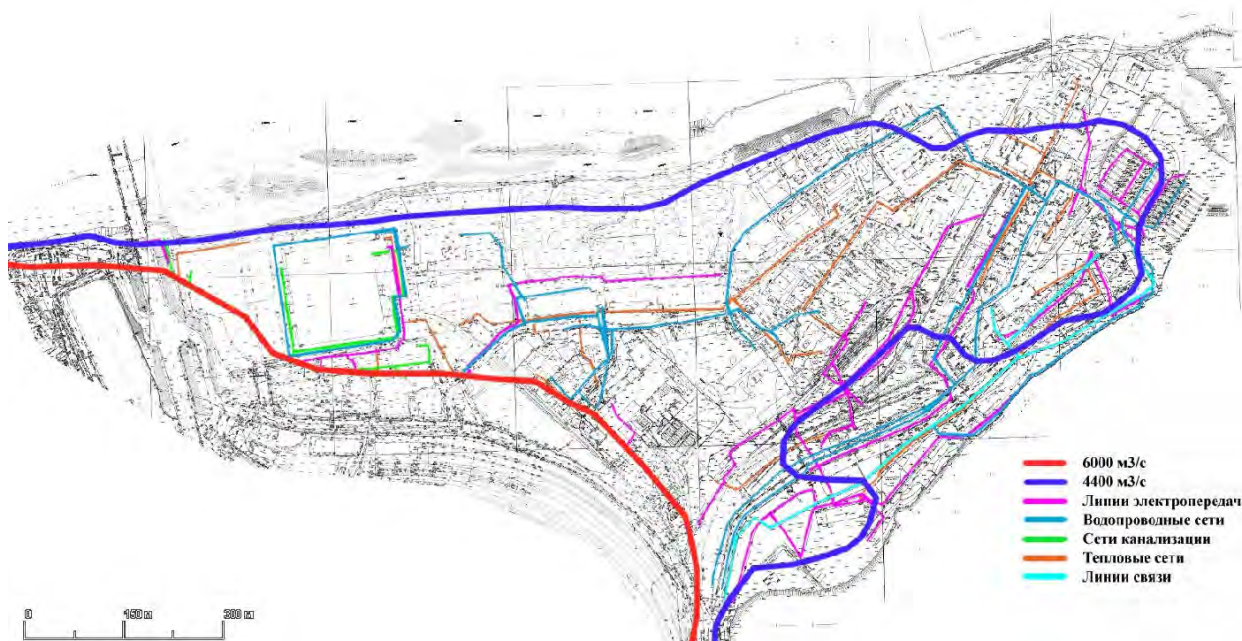
Рисунок 2.1.8 – Определение параметров подземных коммуникаций, попадающих в зону затопления
