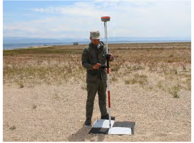
Рисунок 2.2.6 – Слева: пример размещения опознаков, справа: определение координат и высот опознака с использованием ГНСС-приемника
