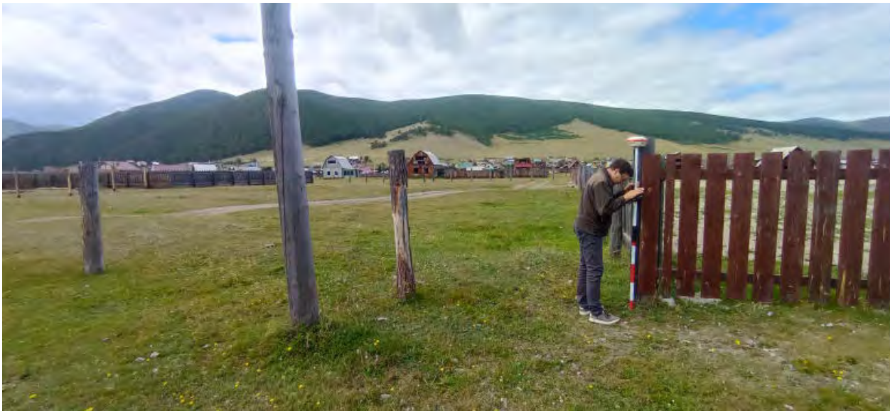
Рисунок 2.2.5 – Планово-высотная привязка опознаков
