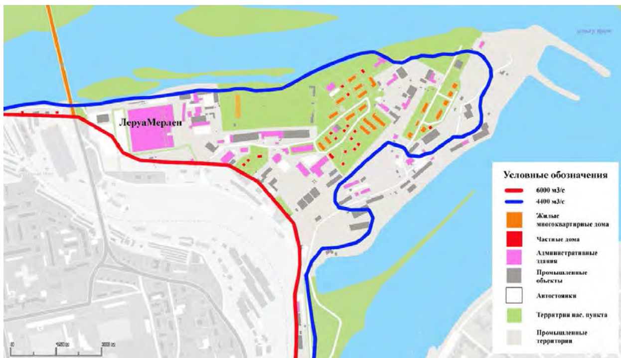
Рисунок 2.1.7 – Границы затопления г. Иркутск в устье р. Иркут
