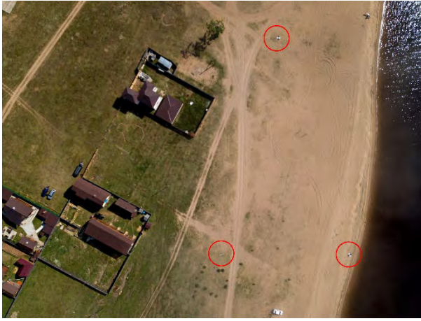
Рисунок 2.2.6 – Слева: пример размещения опознаков, справа: определение координат и высот опознака с использованием ГНСС-приемника
