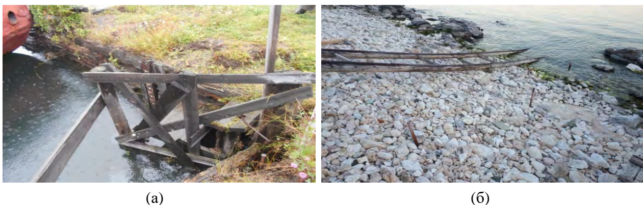
Рисунок 3.2.2 – Уровнемерное оборудование поста р.п. Байкал (а) и о. Большой Ушканий
