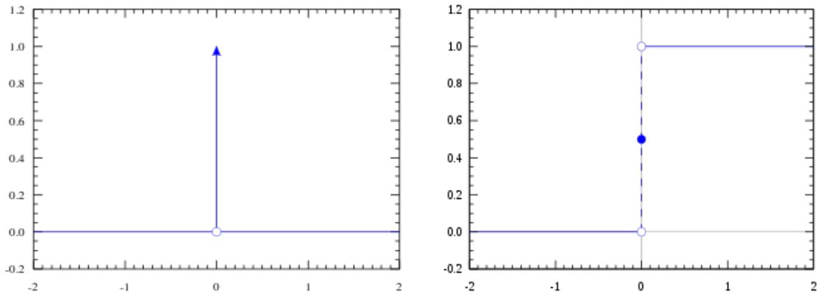
Рисунок 1.3 – Дельта-функция Дирака  $\delta(t)$  (слева), Функция Хевисайда  $\theta(t)$  (справа)
