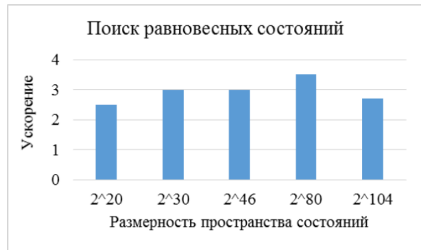
Рис. 7в. Ускорение разработанного решателя в сравнении с традиционным решателем BNS
