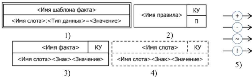
Рис. 3.1.2. Основные элементы RVML: 1) шаблон факта; 2) узловой элемент правила; 3) факт; 4) условие; 5) связи элементов с указанием действий.
